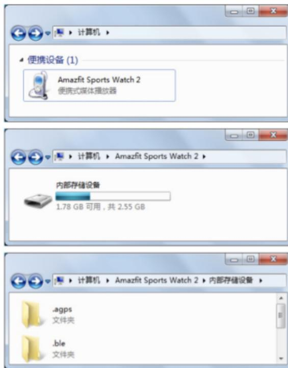
将手表与充电底座连接并与电脑的USB连接后，在“我的电脑”中双击“Amazfit Smartwatch”，进入后双击“内部存储设备”即可访问手表内的文件列表。
